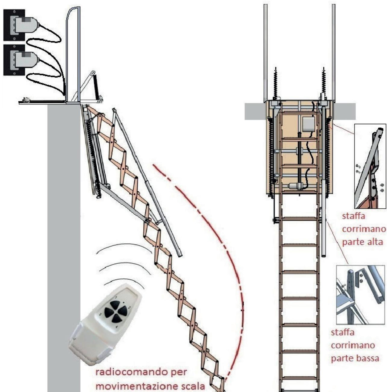
5 La scala a soffietto elettrica è dotata di sgangi per renderla manuale in caso di EMERGENZA.
